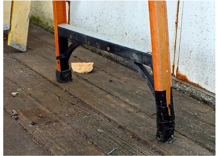
Protector de pie/ensamblaje dañado en esta escalera de peldaños fue arreglado incorrectamente con cinta en un intento por repararla. (*2)
